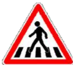
Segnaletica verticale di attraversamento pedonale (segnale stradale A13b)
